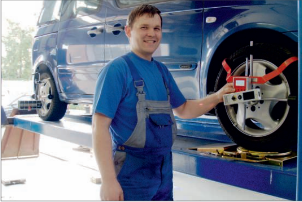
Mit Hilfe des speziellen Achsmess-Stands kann Jürgen Besginow eine exakte Achsvermessung an den Fahrzeugen durchführen.
